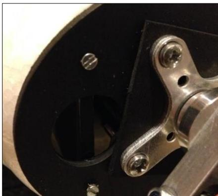
Abb. 21 kleine Schrauben zur Stabilisierung der Motoraufhängung
