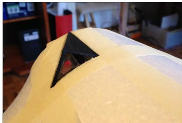
Abb. 22 neue Lüftungsklappen zur besseren Kühlung des Motors
