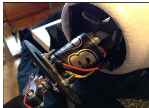
Abb. 20 herausgerissener Motor kurz nach dem Zwischenfall
