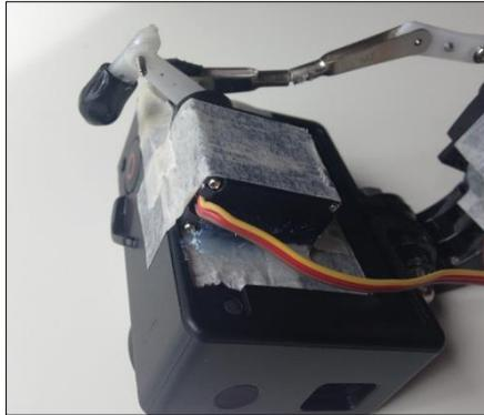
Abb. 36 der auf die GoPro geklebte Auslöseservo
