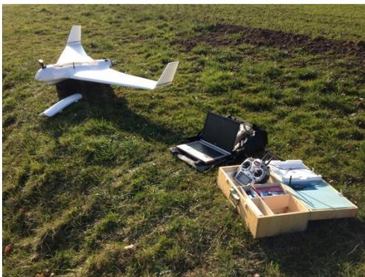
Abb. 24 Aufbau der Bodenstation vor dem Flug
