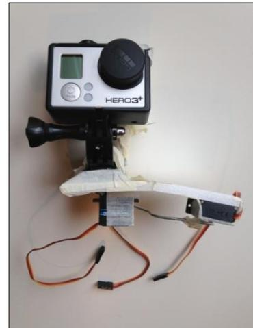
Abb. 29 Prototyp aus Depron mit der GoPro Kamera
