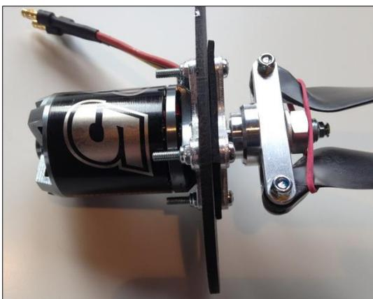
Abb. 17 gedämpfter Motor vor dem Einbau
